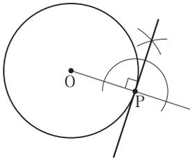
**解き方** 点Pを通る円Oの接線は、円Oの半径である線分OPの垂線になるので、点Pを通る、直線OPの垂線をかきます。
