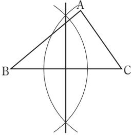
**解き方** 定規とコンパスだけを使って、作図します。作図のときにかいた線は消さないようにしましょう。垂直二等分線のかき方にしたがって、作図をしています。
