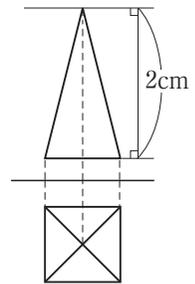
**解き方** 投影図の上部には、立体を正面から見たときの図(立面図), 下部には、立体を真上から見たときの図(平面図)を示します。
